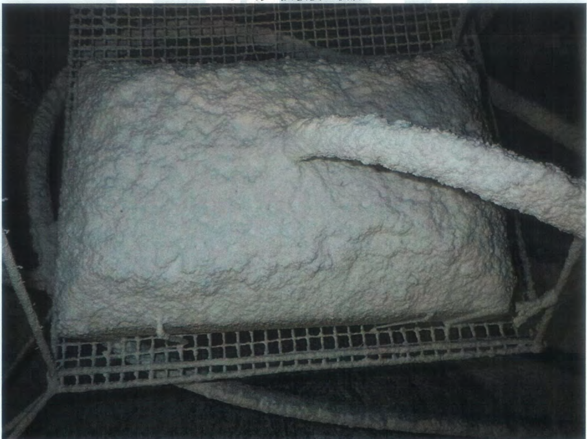
じんあい試験後の状況
